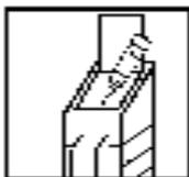
D'abord l'eau, ajouter ensuite le produit. Respecter les dosages sur l'étiquette. En utilisant le système de remplissage rapide, verser la solution de nettoyage par le tuyau dans le réservoir d'eau propre.
