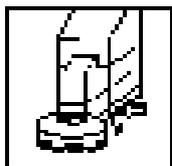
Abaisser le suceur, ouvrir l'arrivée d'eau (solution détergente) selon la vitesse de conduite, abaisser la brosse. Travailler par bandes en faisant chevaucher les lignes de passage. La surface entre le sol et la brosse doit être uniformément mouillée. Le suceur d'aspiration n'est efficace que sur sol mouillé !
